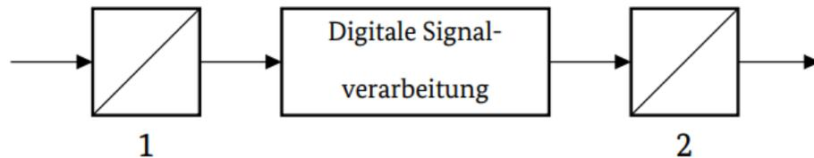
**A** 1: A/D-Umsetzer, 2: D/A-Umsetzer
